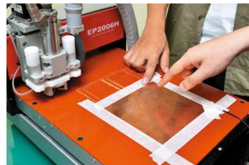
▲ 張允維完成天線設計評估後，使用雕刻機實作天線樣品。
